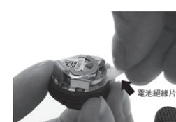
抽出電池絕緣片來連接電池電源，再將 AROFLY 上蓋鎖上轉緊。
