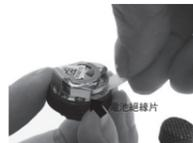
抽出電池絕緣片來連接電池電源，再將 AROFLY 上蓋鎖上轉緊。
