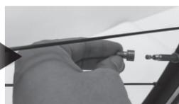
再將 "氣嘴轉接頭" 鎖緊於法式氣嘴上。鎖入前，請確認 "氣嘴轉接頭" 正確方向。
